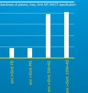
Oksidacija povećava viskozitet ulja, dovodeći do stvaranja naslaga na klipovima koje mogu biti potencijalno štetne.
